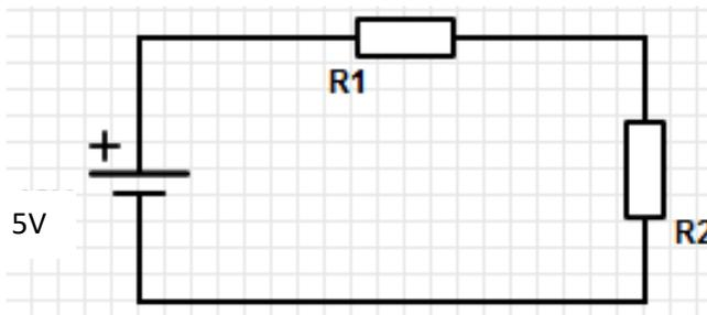
4. Mesurez la tension  $U_{R1}$  aux bornes de R1, puis  $U_{R2}$  aux bornes de R2, et remplissez le tableau :
