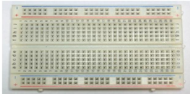
Une telle plaque d'essai est d'une très grande utilité pour réaliser des montages électroniques sans soudure, en association notamment avec une carte à microcontrôleur telle que les cartes Arduino.
