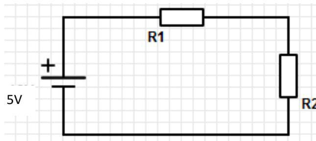
2. Mesurez la tension  $U_{R1}$  aux bornes de  $R_1$ , puis  $U_{R2}$  aux bornes de  $R_2$ , et remplissez le tableau :
