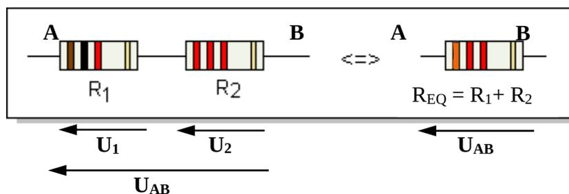
$R_{EQ}$  étant la résistance équivalente qui reprend les mêmes caractéristiques en tension et en courant du montage vu du générateur.
