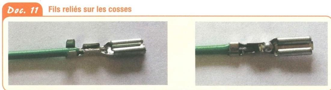
Prendre soin d'étamer les fils souples avant de les positionner. Utiliser de la gaine thermo-rétractable afin de protéger des contacts directs les raccordements électriques, [document 12](#).
