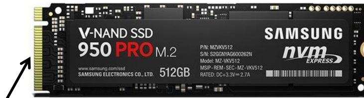
Un SSD au format M2 Nvme (le connecteur est différent du M2 Sata qui possède 2 encoches).
