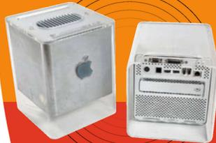
▲ **Power Mac G4 Cube (prototype) 2000** Esthétiquement détonnant, son boîtier cubique de 20 cm de côté concentre toute la technologie d'Apple. Dénué de ventilateur, il était extrêmement silencieux.
